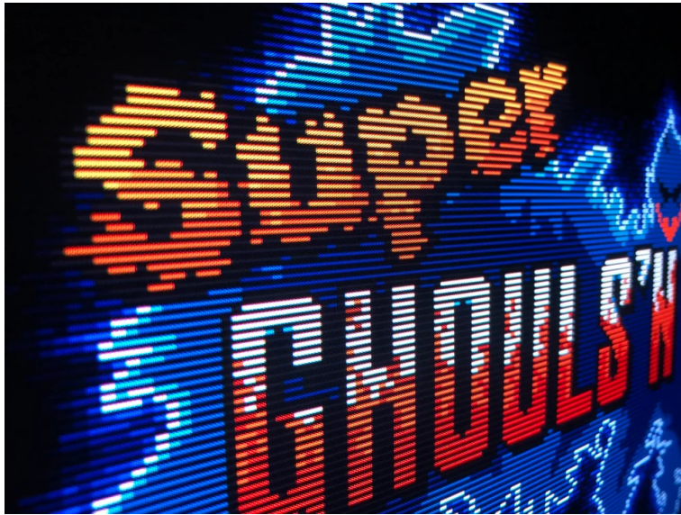
Figura 17 – Exemplo de uma tela reproduzindo os efeitos de CRT, com scanlines (SCAN-LINES, 2019).
