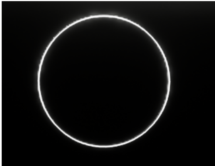
Figura 34 – Imagem de esfera após aplicarmos um shifting à direita, esquerda, cima e baixo. e subtrair a imagem obtida da original.
